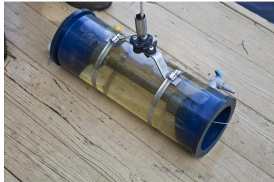
სურათი 5.14. ტბებში, მდინარეებზე, ზღვებსა და ოკეანეებში დიდ სიღრმეებზე სინჯის აღების მოწყობილობები
