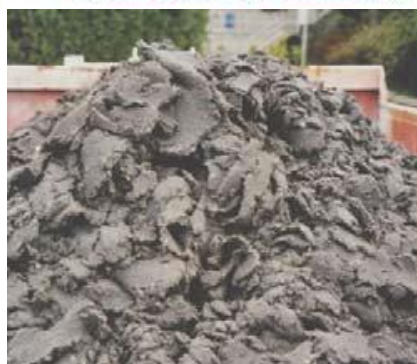
სურათი 8.14. შლამის წარმოქმნა და მოცილება ჩამდინარე წყლის გაწმენდის ნაგებობაზე
