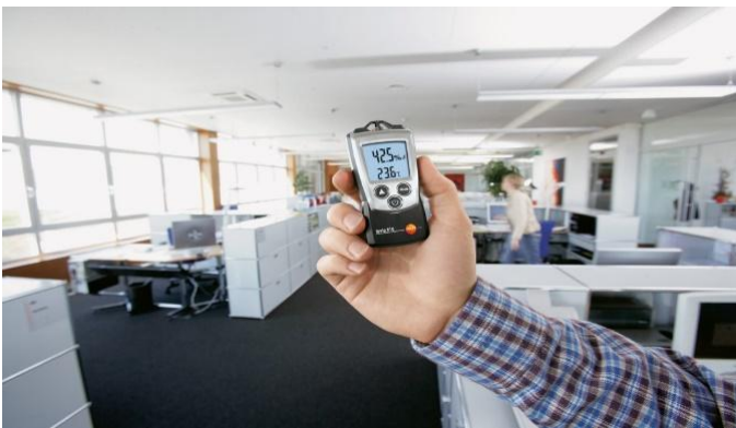
სურ.10.38. ა - ჰაერის მიკროკლიმატის პარამეტრების განსაზღვრა საამქროში, ბ - საამქროში დამონტაჟებული თერმოფსიქრომეტრი
