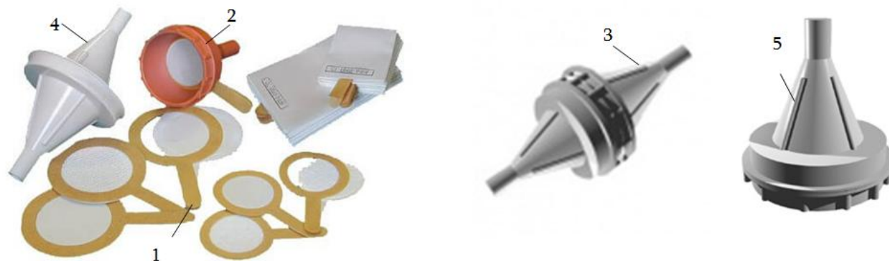
სურათი 7.16. ალონჟები ფილტრებზე მტვრის სინჯის ასაღებად
