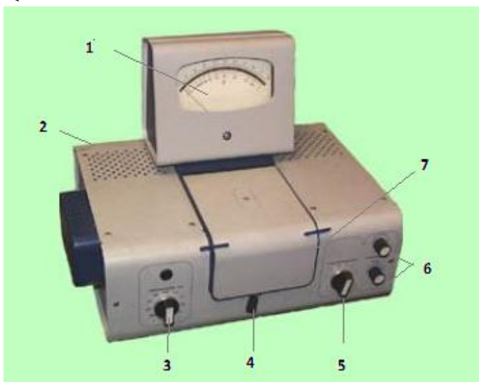
სურათი 6.1. ფოტოკოლორიმეტრი KFK-2. 1. სარეგისტრაციო სკალა, 2. ჩამრთველი, 3. შუქფილტრის გადამრთველი, 4. სახელური კიუვეტების გადასაადგილებლად, 5.6. მგრძნობიარობის გადამრთველები, 7. კიუვეტების ჩასადების სახურავი.
