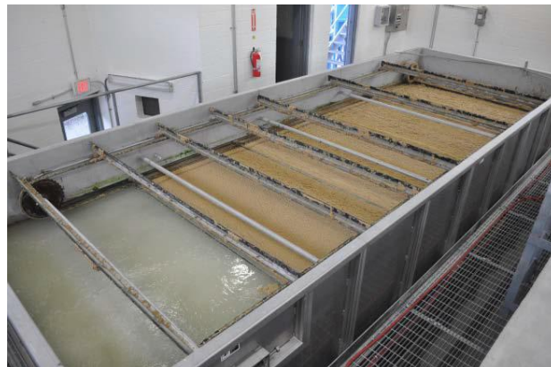
სურათი 8.7. ფლოტაციის პროცესი ჩამდინარე წყლების გაწმენდაში
