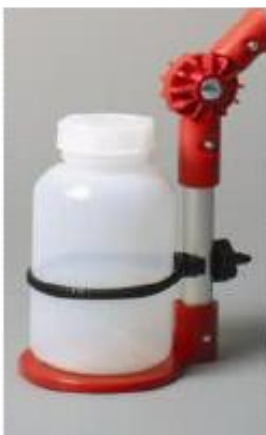
სურათი 5.13. მცირე სიღრმეებიდან სინჯის აღების მარტივი მოწყობილობა
