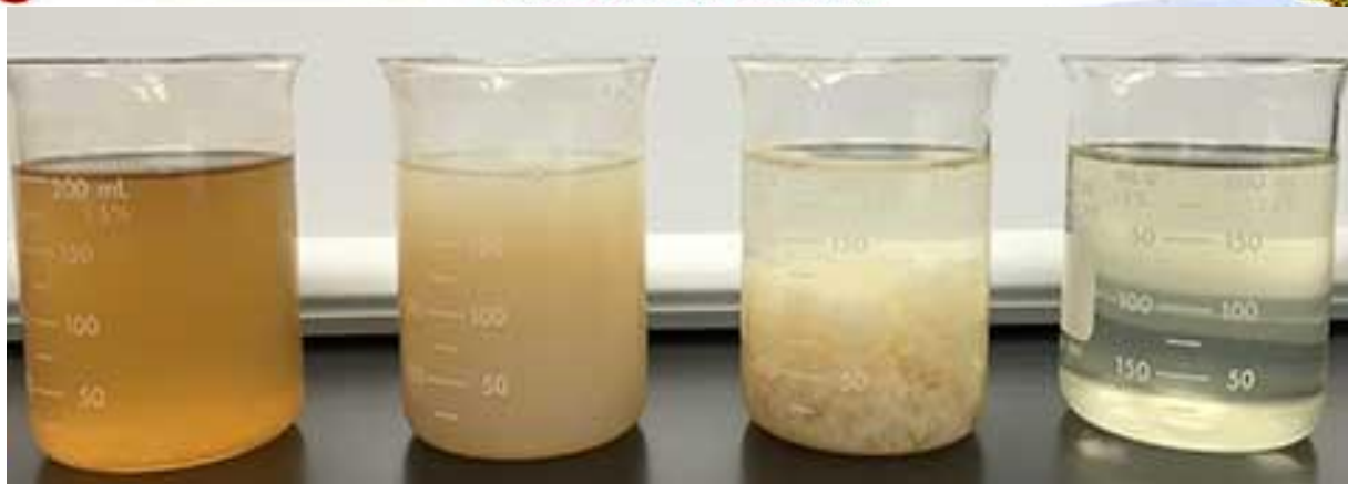
სურათი 8.5. კოაგულანტის მოქმედება - ჩამდინარე წყლის გაწმენდა
