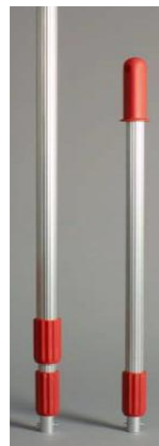
სურათი 5.13. მცირე სიღრმეებიდან სინჯის აღების მარტივი მოწყობილობა
