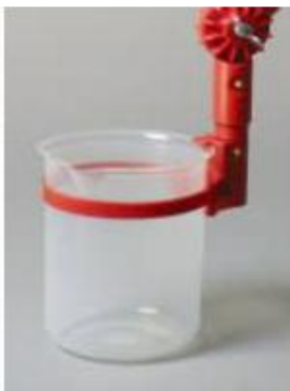
სურათი 5.13. მცირე სიღრმეებიდან სინჯის აღების მარტივი მოწყობილობა
