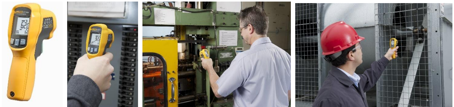
სურ.10.30. ციფრული დისტანციური არაკონტაქტური ხელსაწყო ცხელი ზედაპირების ტემპერატურის განსაზღვრისათვის
