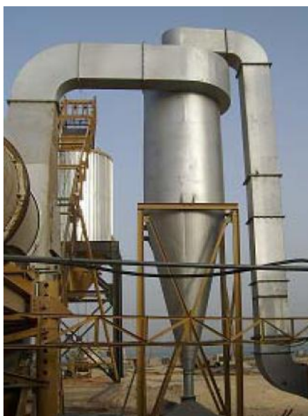
სურათი 7.6. ციკლონის კონსტრუქციები სხვადასხვა სამრეწველო საწარმოში
