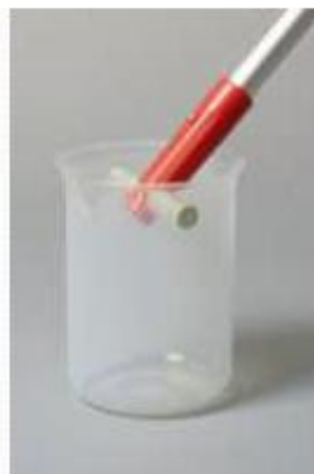
სურათი 5.13. მცირე სიღრმეებიდან სინჯის აღების მარტივი მოწყობილობა
