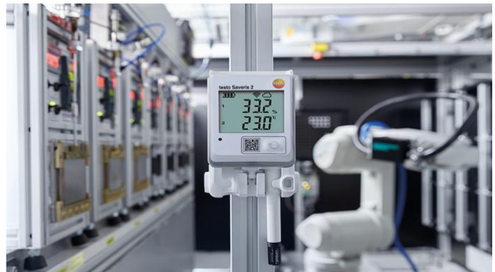
სურ.10.38. ა - ჰაერის მიკროკლიმატის პარამეტრების განსაზღვრა საამქროში, ბ - საამქროში დამონტაჟებული თერმოფსიქრომეტრი
